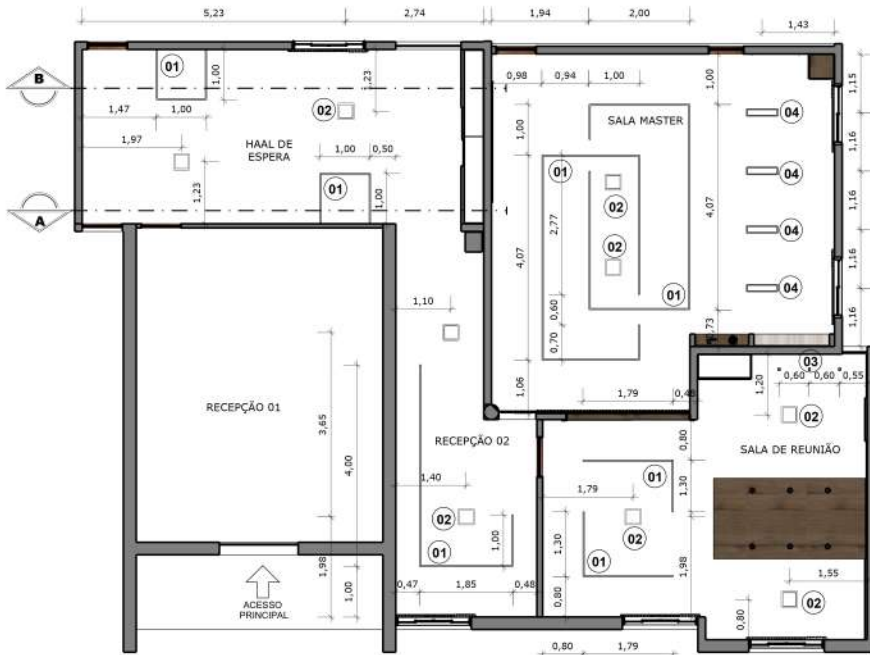
01 DETALHAMENTO GESSO ESCALA: 1/75
